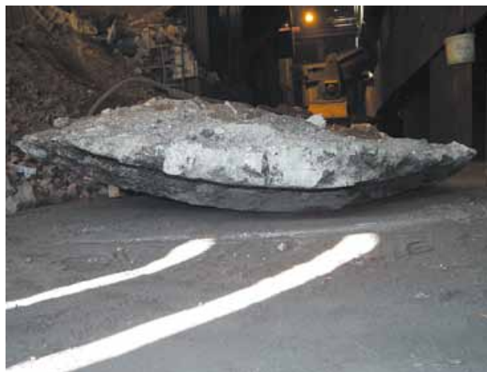
A keverő alján megdermedt nyersvaspadvány, az úgynevezett „medve” ezúttal meglehetősen kis méretű, 20-30 tonna közötti volt, ami a berendezés hatékony működését jelzi
