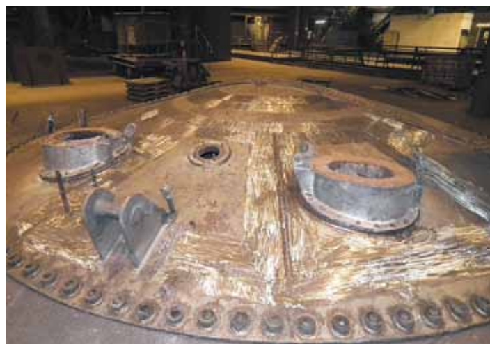
A leszerelt donga, ultrahangos varratvizsgálatra előkészítve
